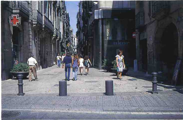
車止めは油圧式で地中に埋設されるようになっていて、時間帯によって歩行者専用になったり、自動車が通行できるようになったりする
