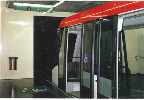
最前部車いす用出入口とそれを示すマーク (モンジュイックケーブルカー車両)
